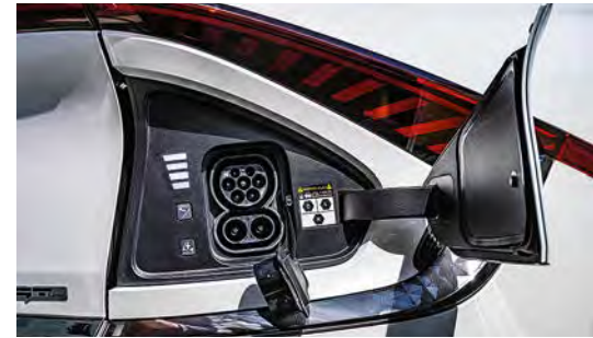
So sieht eine Schnellladebuchse aus. Sie kann natürlich auch Normalladen.
