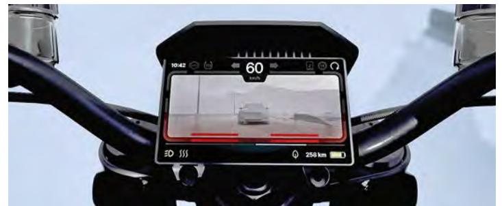
Das Display zeigt beim Blinken das Bild der Rückfahrkamera.
