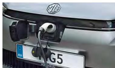
**MG5: Innenraum ohne Überfrachtung. Geladen wird vorne, bidirektionales Laden ist möglich.**
